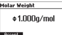
Dùng phím **mũi tên** để thay đổi giá trị. Nhấn **Accept** để xác nhận hay **ESC** để thoát.
