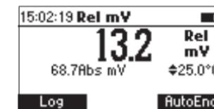
Lưu ý: Nếu sử dụng điện cực pH khi đang ở chế độ đo mV, máy sẽ đo mV tương ứng với điện cực pH.
